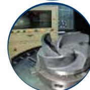
Rotores balanceados dinámicamente que prolongan la vida útil de los rodamientos del motor.
