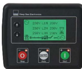
DSE 4610 Módulo de control de arranque automático DSE4620
